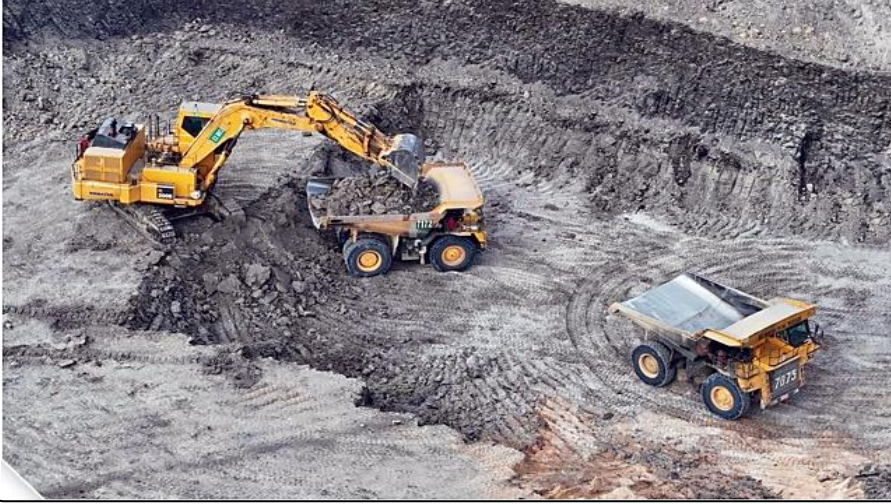
الشكل (13): استخراج الفحم الحجري باستخدام مجموعة من الأدوات، مثل: الحفارات، و شاحنات النقل.
