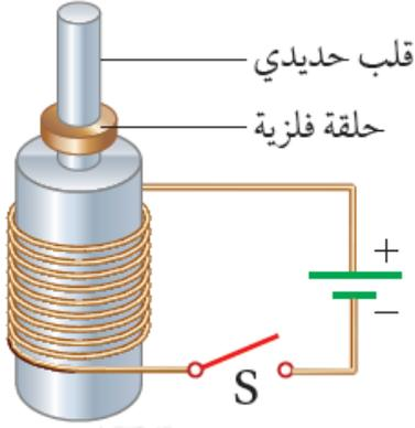
**أحلل وأستنتج:** ملف لولبي ملفوف على قلب حديدي، وفوقه حلقة فلزية حرة الحركة، على نحو ما هو موضح في الشكل المجاور. عند إغلاق المفتاح (S) تقفز الحلقة الفلزية إلى الأعلى. أفسّر هذا السلوك للحلقة.
