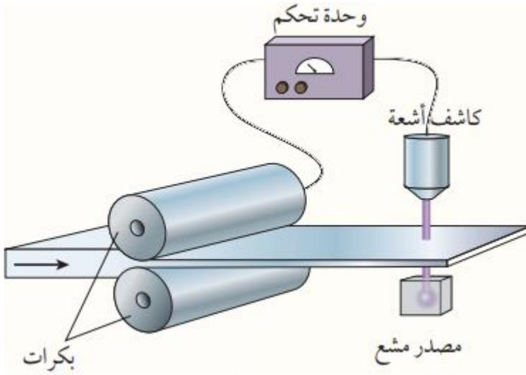
**التفكير الناقد:** تستخدم الأشعة النووية في التحكم في سمك المواد المصنعة على نحو ما هو مبين في الشكل، حيث يوضع أسفل الشريط مصدر مشع، وتستقبل الأشعة بعد نفاذها من الشريط عن طريق كاشف يرسل بدوره إشارة إلى جهاز التحكم عن مقدار الأشعة التي وصلت إليه، فأى الأشعة النووية أفضل في هذا الاستخدام؟ ولماذا؟
