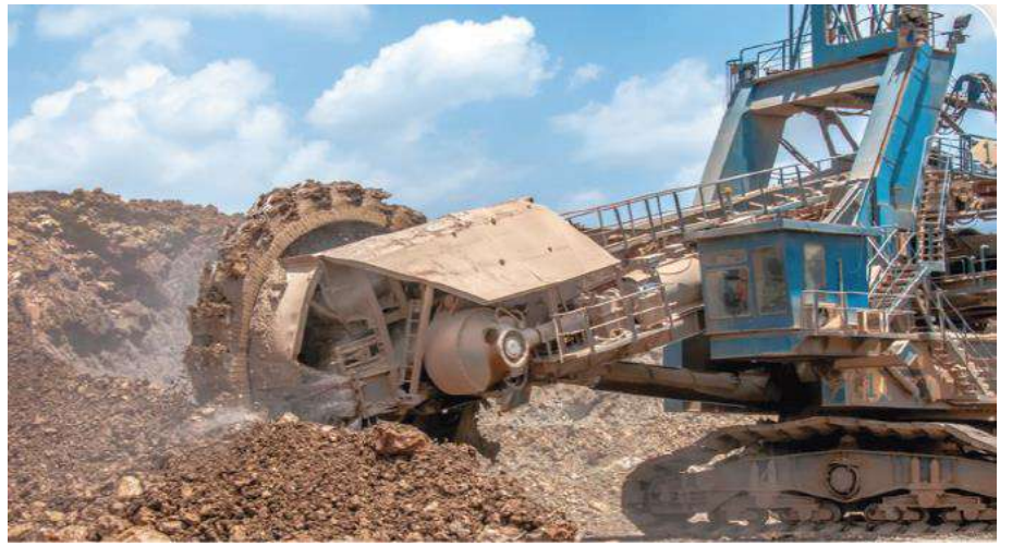
الشكل (14/1): جرافة ذات عجلات ضخمة تستخدم في إزالة الصخور التي تحتوي على الخامات المعدنية في أحد مناجم التعدين السطحية.
