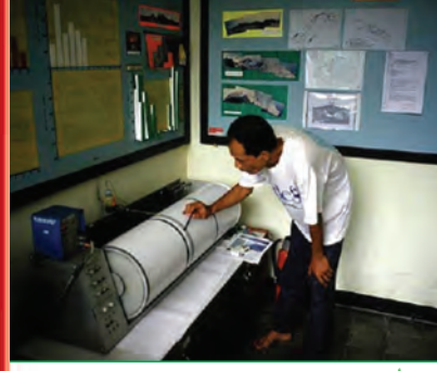
تسجيل الموجات الزلزالية في محطة الرصد
