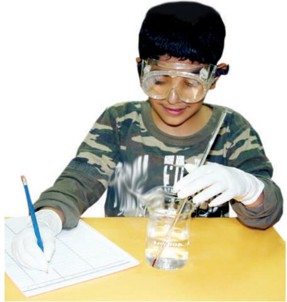
الشكل ١٤ يستعمل مقياس درجة الحرارة لقياس درجة حرارة الأجسام. ومعظم مقاييس درجة الحرارة في المختبرات هي عبارة عن أنبوب زجاجي في نهايته مستودع، يحتوي على سائل مثل الكحول الملون. ويرتفع السائل في الأنبوب أو ينخفض كلما تغيرت درجة الحرارة. ولقراءة درجة الحرارة حرك المقياس بشكل دائري حتى تتمكن من مشاهدة السائل الملون، واقراء درجة الحرارة عند نهاية السائل.
