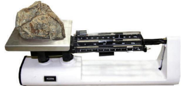
الشكل ١٢ يستخدم الميزان الثلاثي الأذرع لقياس كتلة جسم.
