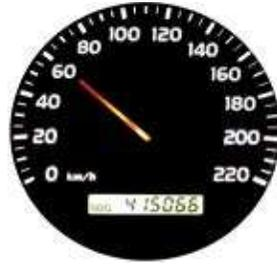
الشكل ٢ يقيس عداد المسافة في السيارة المسافة التي قطعها، بينما يعطي مقياس السرعة، السرعة اللحظية. صف كيف تستعمل عداد المسافة لحساب السرعة المتوسطة؟
