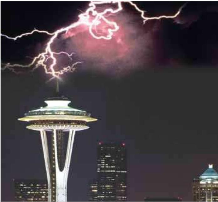
الشكل ٩ توفر مانعة الصواعق مسارًا لتوصيل الشحنات الكهربائية من الصاعقة إلى الأرض.
