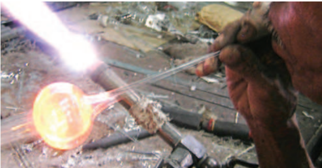
الشكل ٩ يبدأ الزجاج في الليونة تدريجياً عند تسخينه بدلاً من انصهاره وتحوله إلى سائل. ويستخدم صانعو الزجاجيات هذه الميزة في تشكيل الزجاج.
