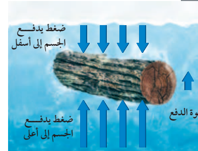
يؤثر الوزن نحو الأسفل وتؤثر قوة الدفع نحو الأعلى، وبتساوي القوتين يطفو الجسم.
