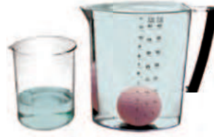
الشكل ٢١ عندما سقطت الكرة في الإناء الأكبر المملوء بالماء أزاحت بعضه، وقد تم جمع الماء المزاح في الإناء الأصغر. تواصل. ماذا تعلم عن وزن الماء المزاح وحجمه؟
