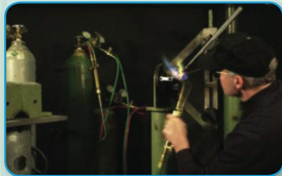
L'oxygène est utilisé avec l'acétylène dans la soudure des métaux
