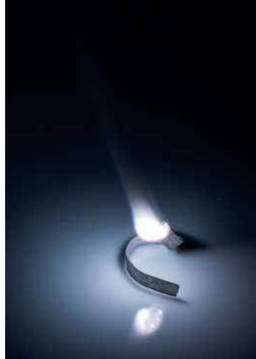
الشكل (3): تفاعل فلز المغنيسيوم مع الأوكسجين. ما لون الضوء الصادر عن احتراق فلز المغنيسيوم؟
