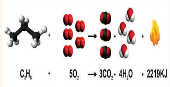
نلاحظ من الشكل التوضيحي للتفاعل الطارد للطاقة، أنّ طاقة المواد المتفاعلة أكبر من طاقة المواد الناتجة.
