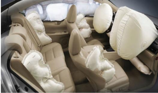
عندما يحدث الاصطدام، تقوم مجموعة من المجسّات الموجودة في وحدة التحكم الإلكتروني بإغلاق الدارة الكهربائية التي تحوي بداخلها مكثفًا كهربائيًا، يوفر شحنة كهربائية قادرة على بدء التفاعل الكيميائي بين المواد الموجودة داخل أسطوانة صغيرة بجانب المخدّة الهوائية، وبعد ذلك تحدث سلسلة من التفاعلات الكيميائية، حيث يكون أحد المواد
