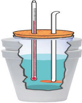
يتكون هذا المسعر من كأسين من مادة البوليستايرين، أحدهما مدخل في الآخر، ومثبتان في كأس زجاجي، ولهما غطاء عازل يدخل فيه ميزان حرارة، وقضيب زجاجي للتحرريك، ولقياس حرارة تفاعل ما، توضع كتل محددة من المواد المتفاعلة فيه، ثم تقاس درجة الحرارة العليا (للتفاعل الطارد للحرارة) أو الدنيا (للتفاعل الماص للحرارة) التي تصل إليها المواد بعد تحولها إلى نواتج، ومن ثمّ يمكن حساب كمية الحرارة الممتصة أو المنبعثة أثناء التفاعل.
