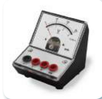
الفولتميتر جهاز يستخدم لقياس فرق الجهد الكهربائي
