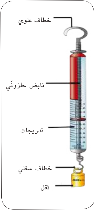
يستخدم الميزان النابضي لقياس وزن الجسم (للاطلاع)
