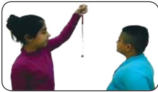
يعلق الميزان النابضي بصورة عمودية عند قياس وزن الجسم
