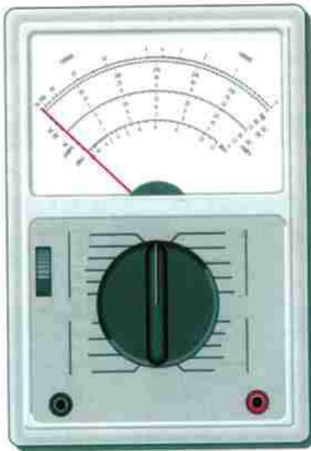
Fig ( 2 – 17) Analog multimeter
