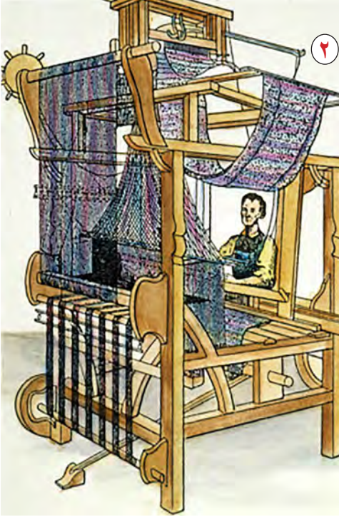
الشكل (١١): ١- نول الجاكار الميكانيكي المستورد. ٢- نول دمشقي من الخشب.
