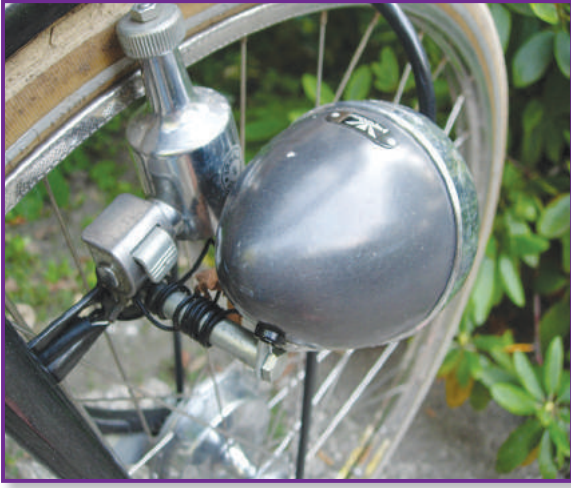
يتصل المولد الكهربائي بعجلة الدراجة
