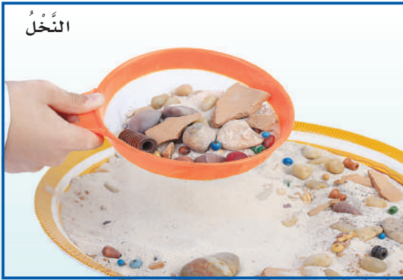
يستخدم المنخل لفصل مواد مختلفة الحجم.
