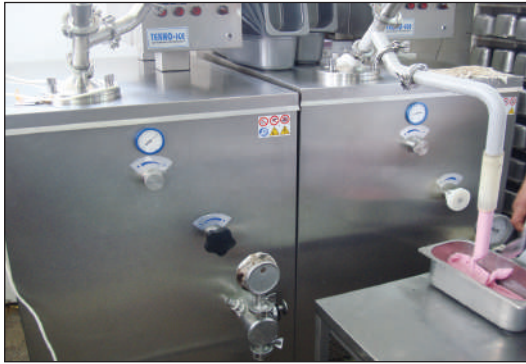
الشكل (٢٣-١): جهاز خلط الثلجات.
