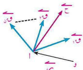
$$\begin{aligned} \text{مجموع عزوم القوى بالنسبة للنقطة و} \\ &= \vec{r} \times \vec{F}_1 + \vec{r} \times \vec{F}_2 + \dots + \vec{r} \times \vec{F}_n \\ &= \vec{r} \times (\vec{F}_1 + \vec{F}_2 + \dots + \vec{F}_n) \\ &= \vec{r} \times \vec{H} \end{aligned}$$
