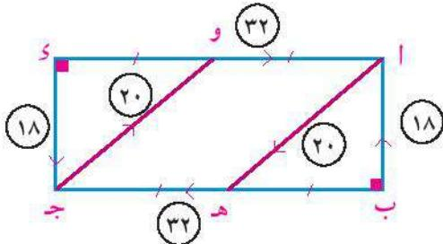
٢ في الشكل المقابل:  $\overline{AB}$   $\overline{CD}$  مستطيل هـ، و منتصفات  $\overline{BG}$ ،  $\overline{AD}$  على الترتيب  $\text{أب} = 6\text{ سم}$ ،  $\text{بـ ج} = 6\text{ سم}$ . فإذا كانت القوى المؤثرة بالنيوتن ومقاديرها واتجاهاتها كما بالشكل. أثبت أن المجموعة متزنة.
