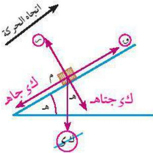
$$\begin{aligned} \text{معادلة الحركة} \quad F &= m + k \cdot g \\ F &= 9 \times 10 \times 9,8 \times \frac{1}{125} + 9,8 \times 9 \times 20 \\ F &= 252 \text{ نيوتن} \\ F &= 252 \text{ كجم} \end{aligned}$$
