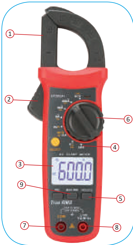
الشكل (1-25): أحد أجهزة الكلامبميتّر .
