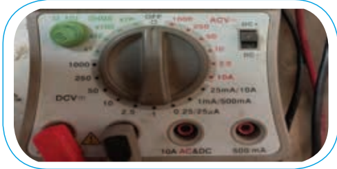
الشكل (1-19): وضع الأسلاك مكانها الصحيح على جهاز الأفوميتر
