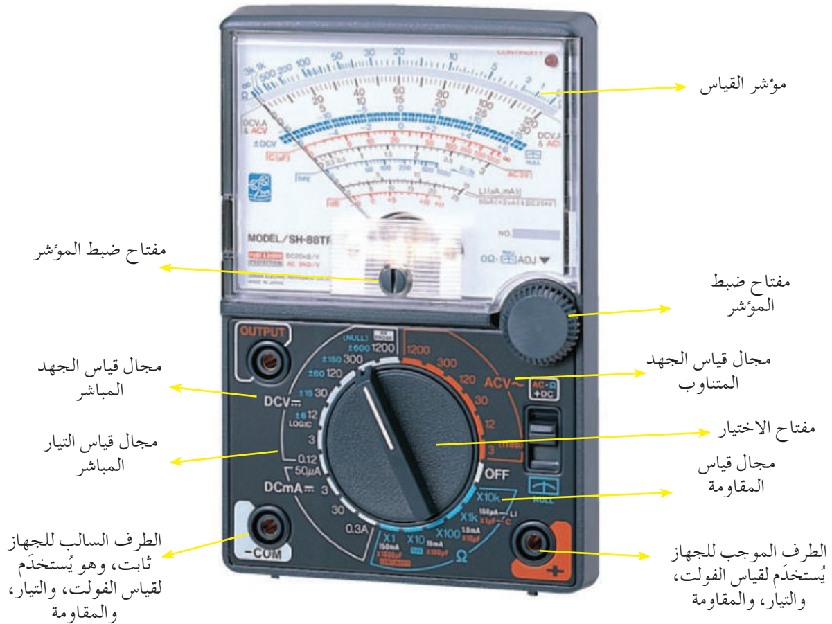
الشكل (1-18): جهاز القياس مُتعدّد الأغراض الأفوميتر.
