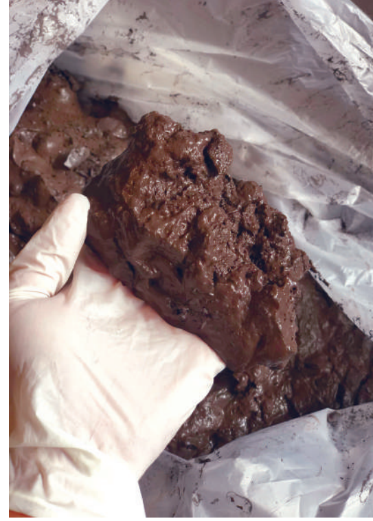
الشكل (12): الحمأة التي ترسّبت في أثناء معالجة المياه العادمة.
