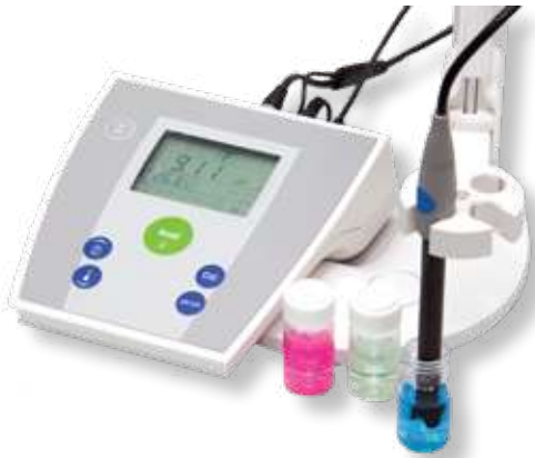
▲ ب- جهاز مقياس الرقم الهيدروجيني.
