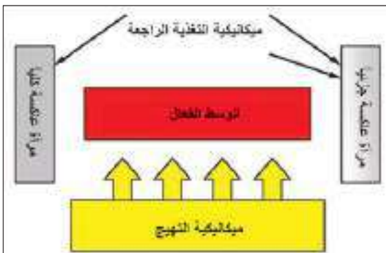
شكل (35) مخطط لمكونات جهاز الليزر
