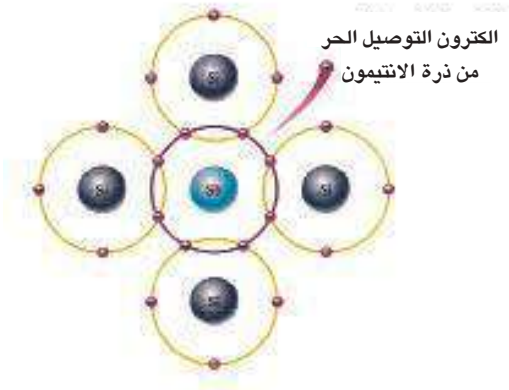
شكل (13) بلورة شبه موصل نوع (N)
