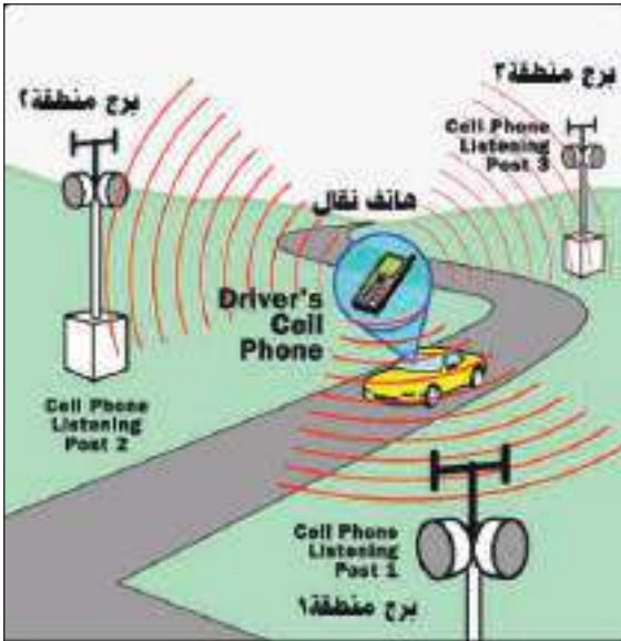
شكل (31) يوضح كيفية امكانية تحويل المتحدث المستقبل من خلية اتصال الى اخرى
