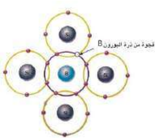
شكل (15) بلورة شبه موصل نوع (P)
