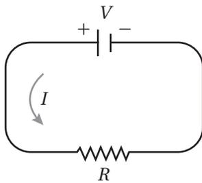
4 تُمثِّل المعادلة:  $V = IR$  جُهد الدارة الكهربائية (بالفولت) المُبيَّنة في الشكل المجاور، حيث  $I$  شدَّة التيار بالأمبير، و  $R$  المقاومة بالأوم. إذا كان جُهد الدارة يزداد بمُعدَّل  $1 \text{ volt/s}$ ، وشدَّة التيار تقل بمُعدَّل  $\frac{1}{3} \text{ amp/s}$ ، فأجد مُعدَّل تغيُّر  $R$  عندما  $V = 12$ ، و  $I = 2$ .
