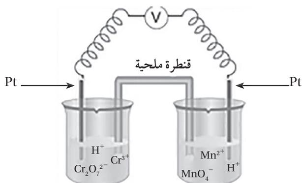
1) أدرُس الشكل المجاور، الذي يمثل خلية جلفانية تتكوّن من نصف خلية  $\text{MnO}_4^-|\text{Mn}^{2+}$  في وسط حمضي، ونصف خلية  $\text{Cr}_2\text{O}_7^{2-}|\text{Cr}^{3+}$  في وسط حمضي؛ حيث استُخدم في كل نصف خلية قطباً من البلاتين الخامل، مُستعيناً بأنصاف تفاعلات الاختزال وجهودها المعيارية الآتية:
