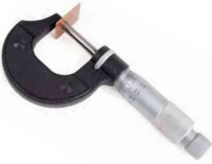
الشكل (3): قياس سُمك صفيحة باستخدام الميكروميتر.
