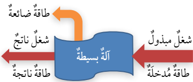
الشكل (14): تحولات الطاقة في الآلة البسيطة.
