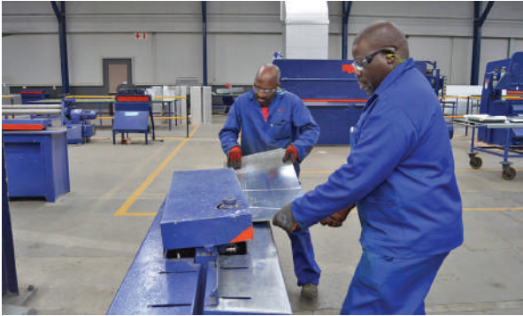
الشكل (14) : طريقة تصنيع مجرى هواء من الصاج المجلفن.
