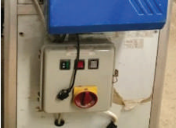
الشكل ( 14 / ب): مفتاح التحكم في عمل فرن الهواء الساخن.
