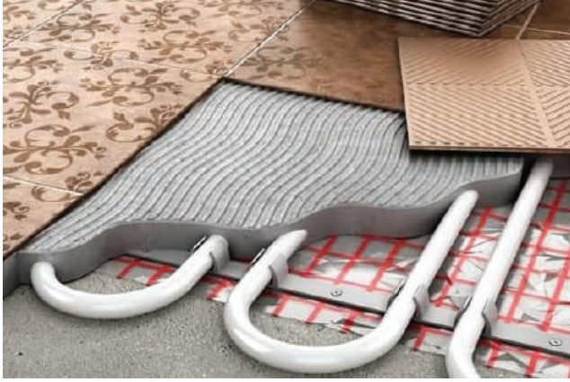
الشكل (9): الصبّة الأسمنتية فوق الشبكة ثم البلاط.
