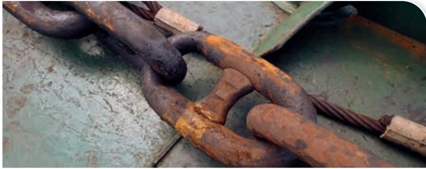
ويتكون صدأ الحديد نتيجةً لتفاعل فلز الحديد مع غاز الأكسجين بوجود الماء (الرطوبة)، فتظهر على سطحه مادةٌ صلبةٌ بُنيَّةٌ هشةٌ تختلف في لونها وصلابتها عن الحديد كما في الشكل (7).
