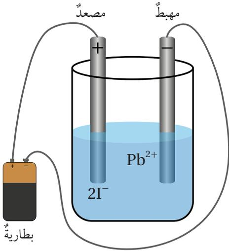
عند تمرير تيار كهربائي في المصهور، تتحرك أيونات الرصاص الموجبة  $Pb^{2+}$  باتجاه المهبط، وتختزل، مكونة ذرات الرصاص  $Pb$ ، في حين تتحرك الأيونات السالبة  $2I^{-}$  باتجاه المصعد وتتأكسد، مكونة جزيئات اليود  $I_2$  كما توضح المعادلات الآتية:
