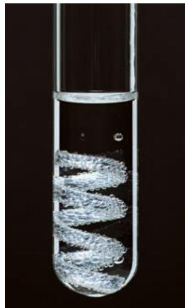
الشكل (9): تفاعل Mg مع حمض HCl المخفف.
