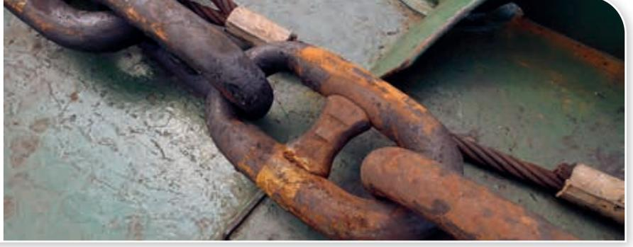
ويتكوّن صدأ الحديد نتيجة تفاعل فلز الحديد مع غاز الأوكسجين بوجود الماء (الرطوبة)، فتظهر على سطحه مادة صلبة بيضاء هشة تختلف في لونها وصلابتها عن الحديد كما في الشكل (7).
