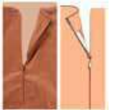
الشكل (٣-١٨): التركيب المخفي للسحاب.
