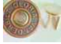
الشكل (٣-٣٦): زر يُبَتَّ باستعمال المكبس.
