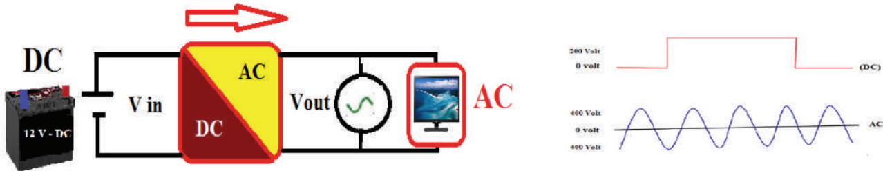
الشكل (33-4): العاكس الكهربائي وإشارتا الدخل والخروج له.
