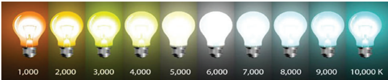
الشكل (5-83): علاقة درجة الحرارة بلون المصباح.
