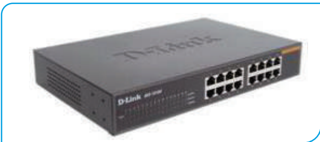
الشكل (81-6): مفتاح التوزيع Switch.
