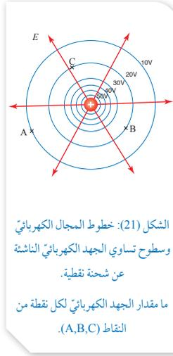
الشكل (21): خطوط المجال الكهربائيّ وسطوح تساوي الجهد الكهربائيّ الناشئة عن شحنة نقطية.
