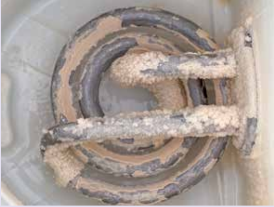
الصورة ١-١ ترسبات كلسية من كربونات الكالسيوم والماغنيسيوم في أنابيب نقل المياه وغلايات وسخانات المياه المنزلية.
