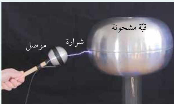
الصورة ٢-٣ ينتج مولد فان دي جراف فرق جهد كهربائي يحدث شرراً عبر الهواء.
