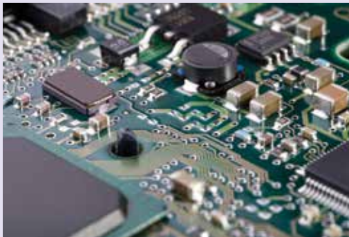
الصورة ١-٣ دائرة إلكترونية معقدة تسمى اللوحة الأم تتحكّم في محرك الأقراص الصلبة في جهاز الحاسوب.
