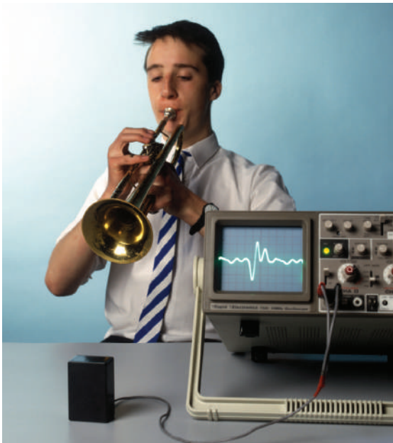
الصورة ١٤-٤ عرض للاهتزازات النغمات الموسيقية، على شاشة جهاز رسم الذبذبات
