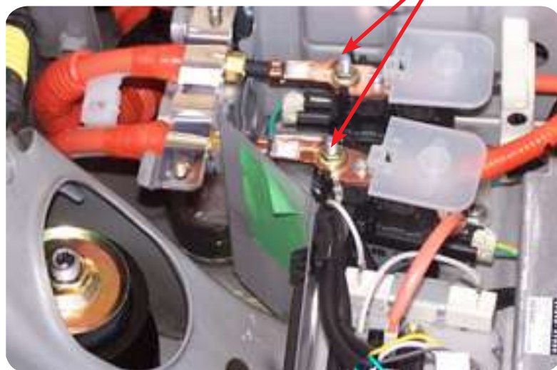
الشكل (6 - 60): التوصيلات الكهربائية للمرآم.
