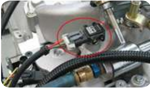
الشكل (6 - 93): حساس قياس الضغط المطلق.
