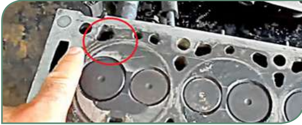
الشكل (5-5): التآكل بين مجاري التبريد المائية ومجرى الزيت
