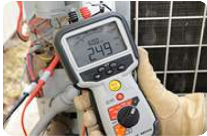
الشكل (6 - 103): جهاز فحص العازلية.
