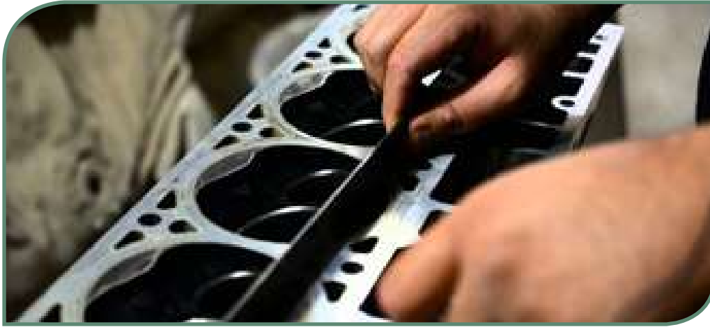
الشكل (5-6): طريقة فحص الاستوائية بأخذ القياسات من أماكن مختلفة.
