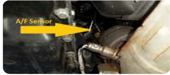
الشكل (6 - 88): حساس قياس نسبة الهواء/الوقود.
