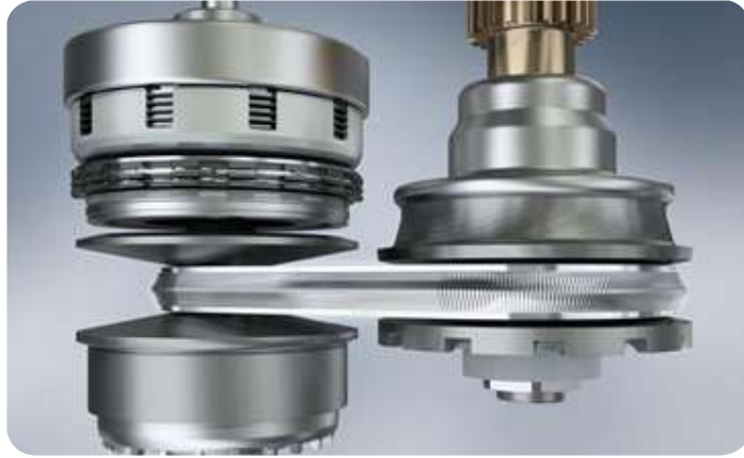
الشكل (6 - 71): مبدأ عمل صندوق السرعات المستمر التغير.
