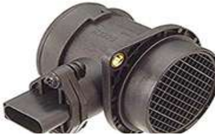
الشكل (6 - 89): حساس قياس كمية الهواء.
