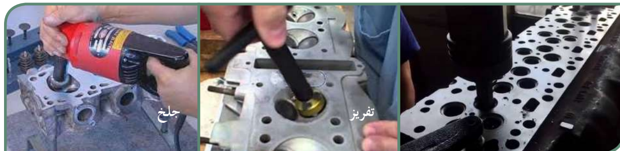
الشكل (5-10): جليخ سطح ارتكاز الصمام (قاعدة الصمام).
