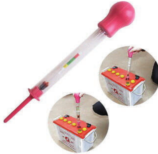
الشكل (2-9): الهيدروميتر جهاز قياس كثافة المحلول.
