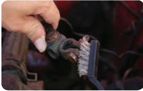
الشكل (2-22): استعمال الفرشاة السلكية لتنظيف المرابط.
