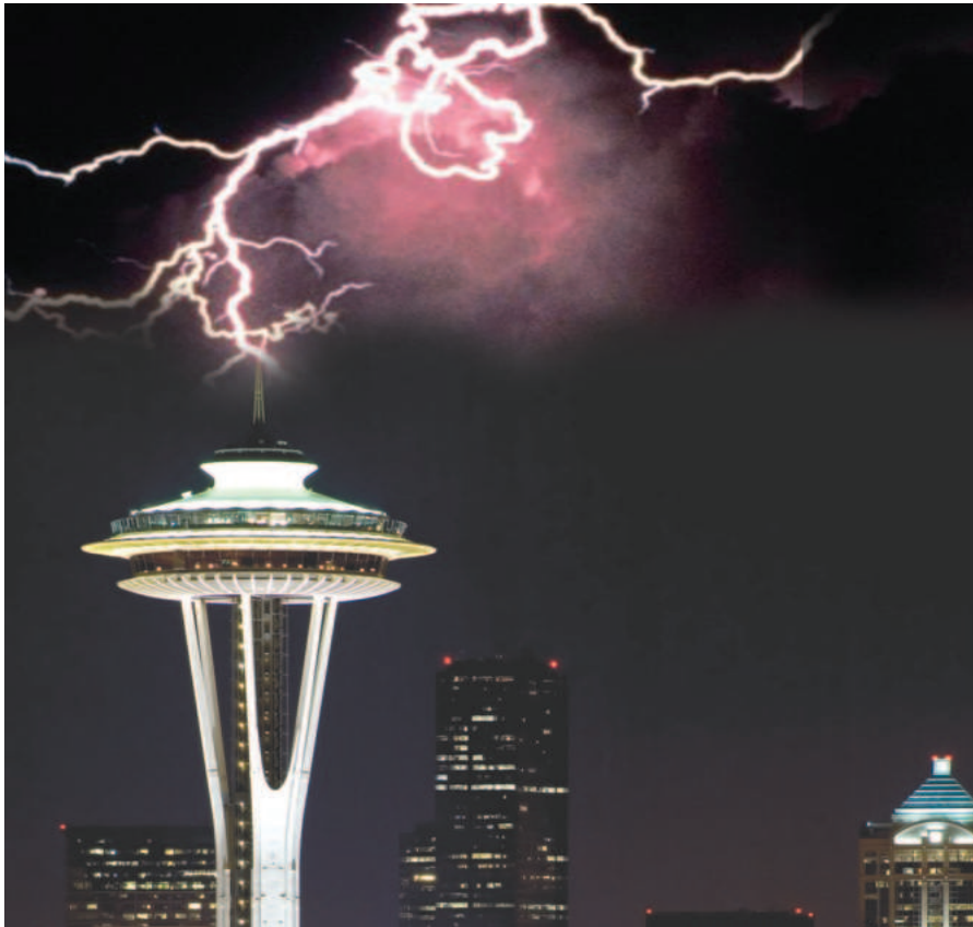
الشكل ٩ توفر مانعة الصواعق مسارًا لتوصيل الشحنات الكهربائية من الصاعقة إلى الأرض.
