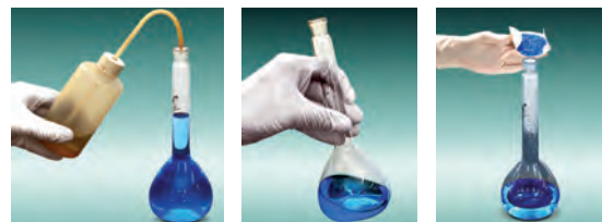
خطوة 1 تقاس كتلة المذاب. خطوة 2 يضاف المذاب إلى قارورة حجمية مناسبة. خطوة 3 يضاف الماء المقطر إلى المذاب حتى يصل مستوى المحلول إلى العلامة المحددة.
