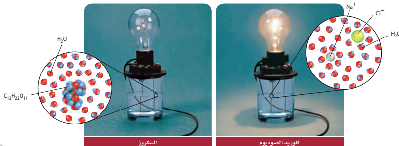
الشكل 16-2 محلول كلوريد الصوديوم موصل جيد للكهرباء؛ وذلك لأنه محلول مادة متأينة. في حين لا يوصل السكروز التيار الكهربائي؛ لأنه محلول مادة غير متأينة.
