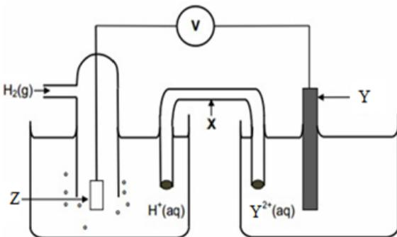
الشكل الآتي يمثل خلية غلفانية في الظروف المعيارية، فإذا علمت أن القطب (Y) تزداد كتلته عند مرور التيار الكهربائي في الأسلاك، وأن قراءة الفولتميتر = 0,70 فولت، أجب عن الأسئلة التي تلي الشكل:
